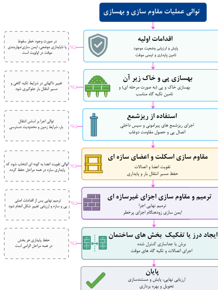
شکل ۵-۱- فلوچارت توالی عملیات ترمیم و مقاوم سازی
